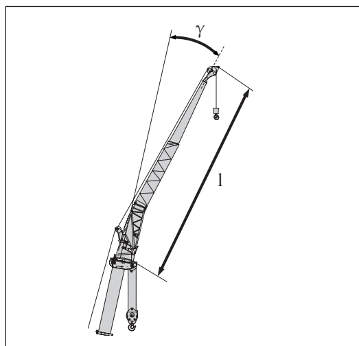
Figura 1-4 Comprimento da lança auxiliar e ângulo de instalação da lança auxiliar
